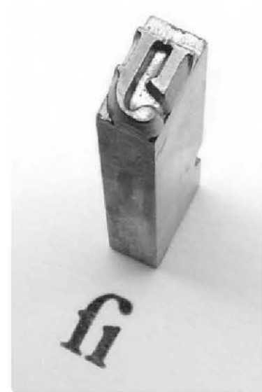
<사진 1> 납활자의 모양. 맨 위는 얼굴(face), 중간은 몸(body), 맨 밑은 발(foot)이라고 부른다.
