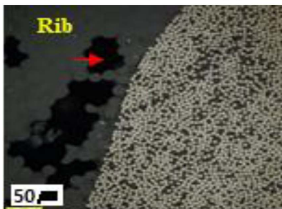
(d) Main rebar + Rib (Scale Bar 50 \mu\text{m} )
