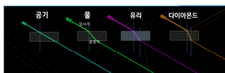
공기 굴절률 1.0 / 물 굴절률 1.33 / 유리 굴절률 1.5 / 다이아몬드 굴절률 2.419 이므로 다이아몬드의 굴절률이 가장 높아서 빛이 가장 많이 꺾인다.
