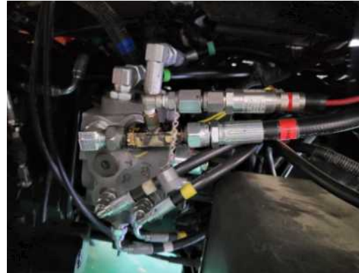
그림 2. 트랙터 자동조향용 비례제어밸브
