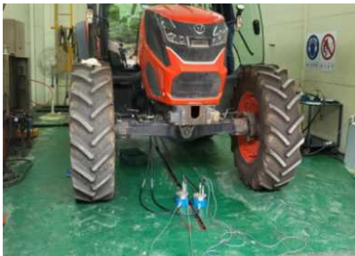
그림 4. 트랙터 조향에 따른 유압 데이터 수집을 위한 실험 Fig. 4. Experiments for collecting hydraulic data according to tractor steering
