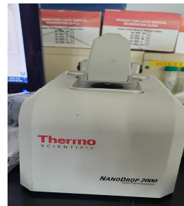
그림 2. DNA순도 및 농도측정을 위한 Nanodrop-1000 Fig. 2. Nanodrop-1000 for DNA purity and concentration measurement
