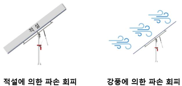
그림 3. 태양광 패널의 파손 및 효율 증대를 위한 회피 구동
