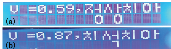
그림 9. 정상, 치석치아의 측정전압 및 0.75V를 기준으로 결과 LCD표시 (a)정상치아, (b)치석치아
