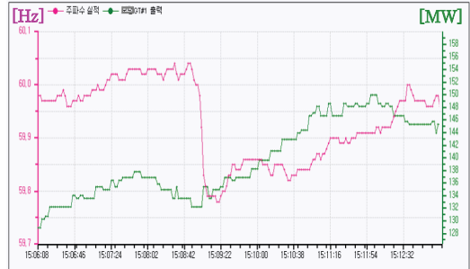
그림 3. 계통주파수 저하시 출력상승 지연 운전 Fig. 3 Power delay operation when Frequency is lowered
