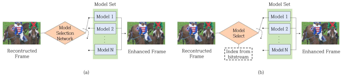
그림 5. 모델 선택 기준에 따른 모델 선택 구조도 (a) 선택 네트워크를 활용한 모델 선택 방식; (b) 모델 인덱스 전송을 통한 모델 선택 방식 Fig. 5. Model selection methods: (a) Selection network; (b) Transmission model indexing.
