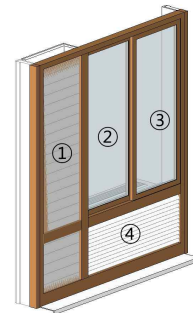
그림 4. 일반적 창문 패밀리 Figure 4. Typical window family
