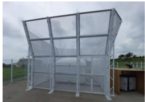
그림 1. 국내 기술로 개발하여 생산한 윈드프로파일러 도플러 레이더.
