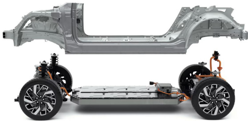
그림 1. 현대자동차의 전기자동차 플랫폼 E-GMP
