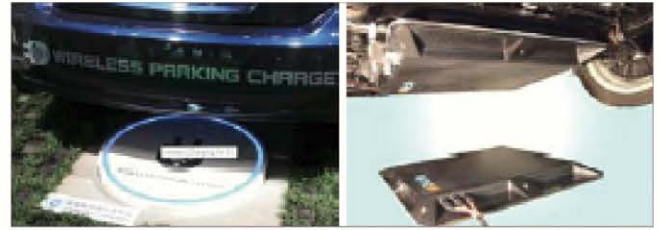
그림 4 도요타의 자기공명 방식 무선 충전기 실증
