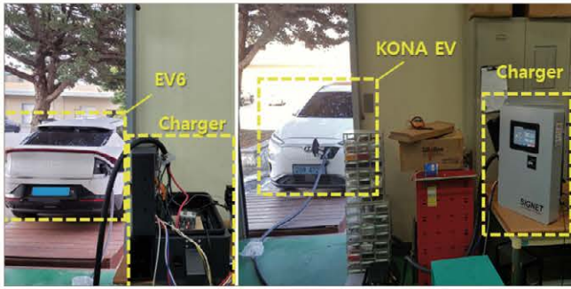
그림 11 EV를 이용한 충전 및 방전 시험
