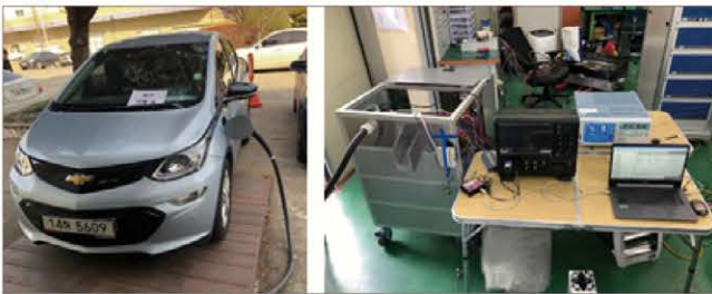
그림 3 EV를 이용한 단방향 파워모듈 시험
