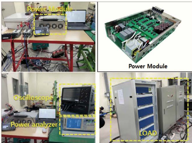
그림 8 개발한 파워모듈 시제품 및 시험 환경
