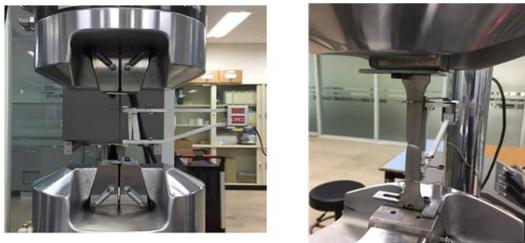
Fig. 2 MTS-809 Tensile tester
