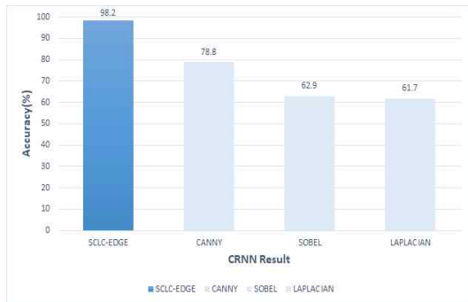
Fig. 7. 1:1 비율의 데이터셋을 사용한 윤곽선 검출 알고리즘의 정확도 측정 결과
