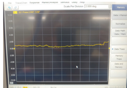
그림 5. 14시간 관측된 위상 정확도 확인 시험 결과 Fig. 5. 14-hour observed phase accuracy verification test result
