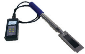
(d) Microwave penetration method (Concrete)
