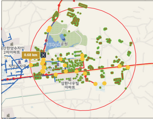
Fig. 2. Methane leak accident (Worst scenario).
