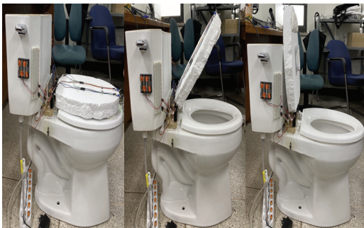
그림 5. 기울기에 각도에 따른 모터 동작 Fig. 5 Motor operation according to the tilt angle
