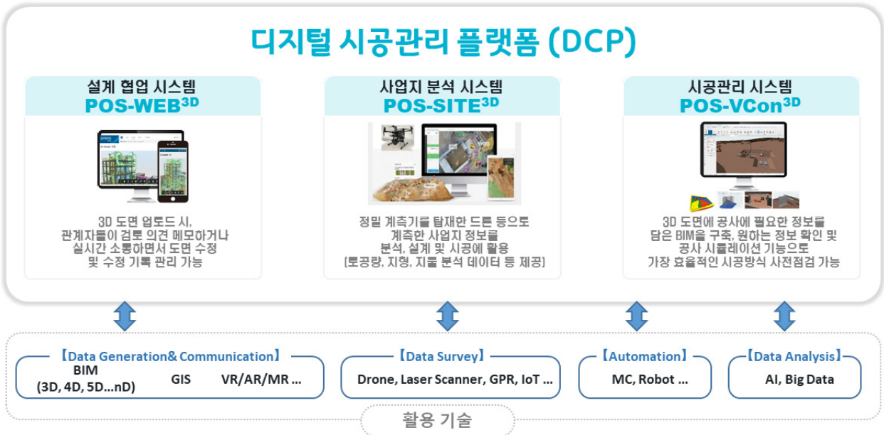
그림 1. DCP 구성 및 활용 기술
