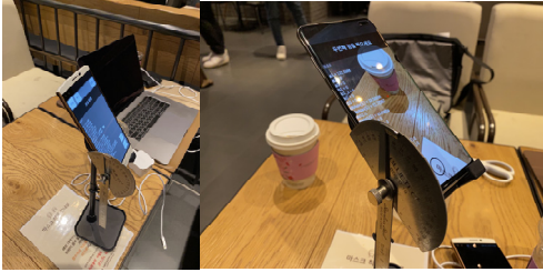
그림 18. 거치대에 회전 각도기를 붙여 실제 각도와 \theta_1 의 비교. Fig. 18. Attach a rotating protractor to the cradle and compare the actual angle and \theta_1 .
