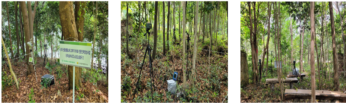
Fig. 2. Installation of mini pump(SIBATA(Japan), MP-Σ30N) for sampling sites 1, 2 and 3.
