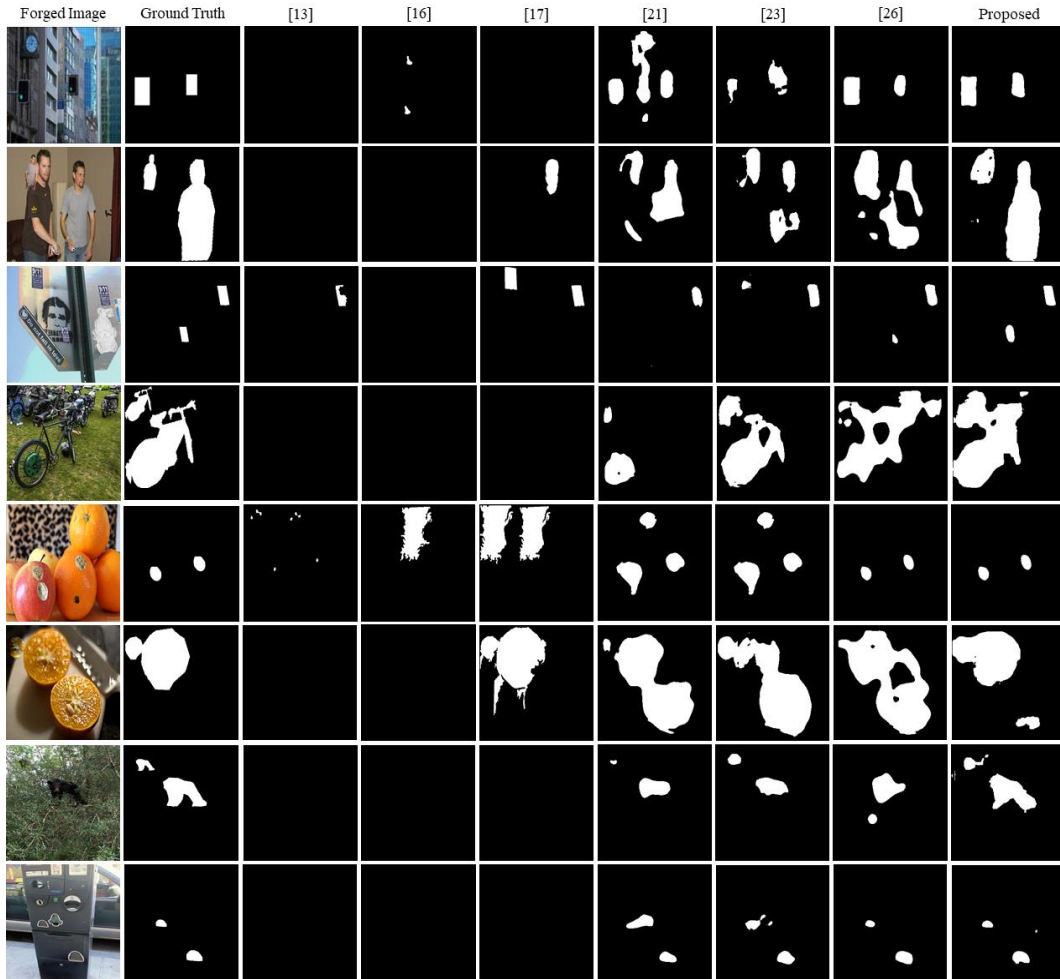
그림 8. 회전 변환이 없는 테스트 영상에 대한 복사-이동 조작 영역 검출 결과 Fig. 8. Copy-move forgery localization results for test images without rotation attack
