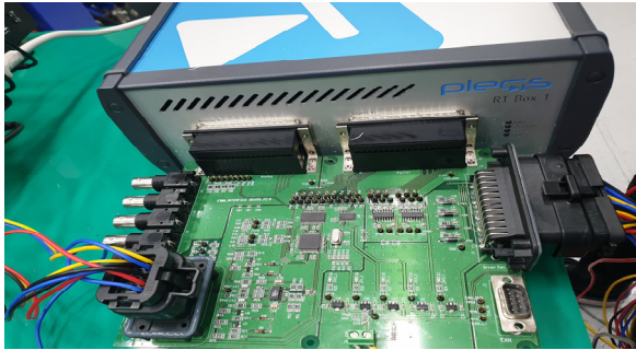
Fig. 9. Controller set consisting of RT-box and I/F board. 그림 9. RT-box 및 I/F보드로 구성된 제어기 세트
