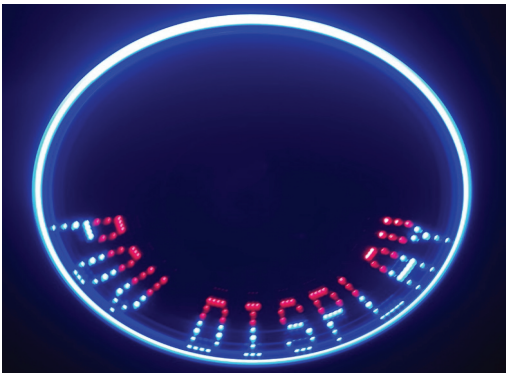
그림 6. 메시지 모드 POV DISPLAY Fig. 6 Display the text "POV DISPLAY" in message mode
