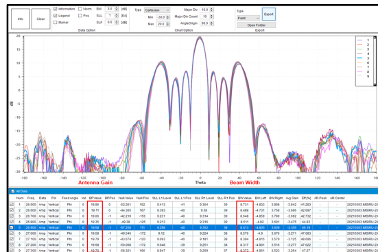
(D) H-Plane Gain of Horn Array Antenna
