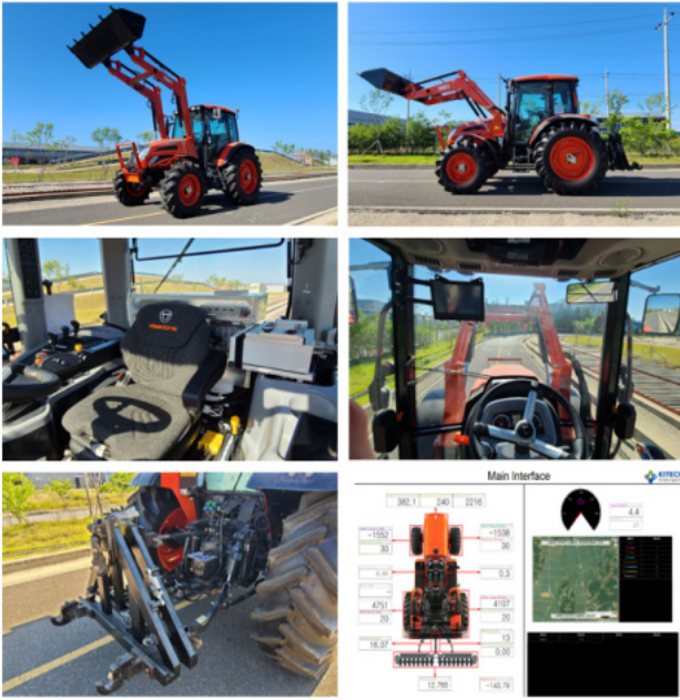
Fig. 3 Actual version of the test tractor
