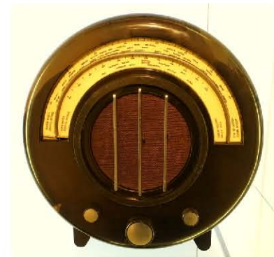
<사진 1> 모델 AD 65 라디오, 디자인: 웰스 코츠, 1932년. 베이클라이트 케이스를 만든 대표적인 라디오.
