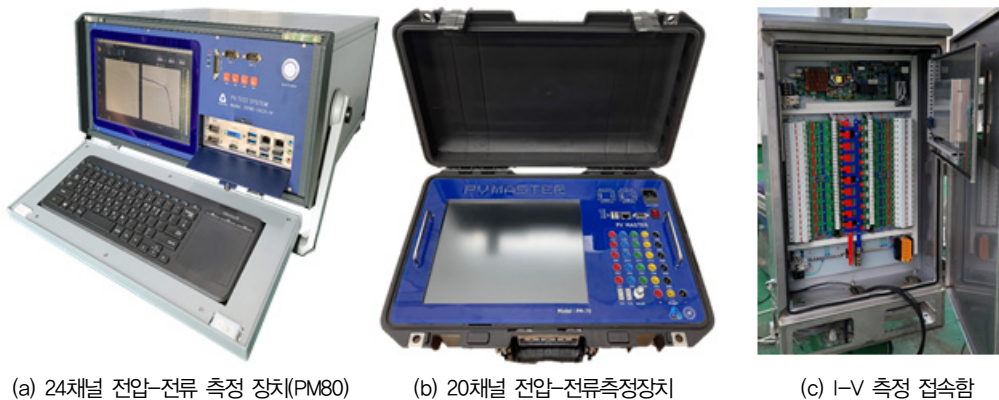
그림 12. 다채널 전압-전류 곡선 측정 장치 및 접속함
