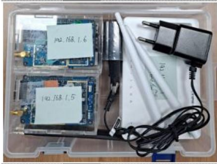
Figure 2. LoRa Reliability Test Facility 그림 2. LoRa 신뢰성 테스트 장비
