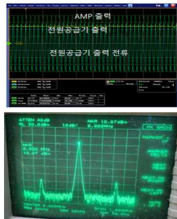
그림 8. Oscilloscope를 이용한 8MHz 고주파 출력 측정 Fig. 8. Measuring 8 MHz High Frequency Power Using Oscilloscope
