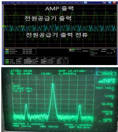
그림 6. Oscilloscope를 이용한 2MHz 고주파 출력 측정 Fig. 6. Measuring 2 MHz High Frequency Power Using Oscilloscope
