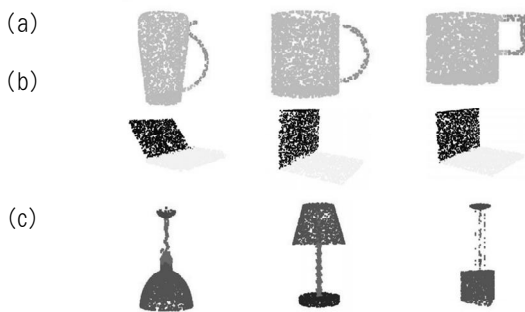
그림 11. ShapeNet-Part 데이터 세트의 (a) Mug, (b) Laptop, (c) Lamp 에서 PointNet의 분할 결과 [16]. Fig. 11. The Segmentation Result of PointNet in (a) Mug, (b) Laptop, and (c) Lamp from the ShapeNet-Part Datasets [16].
