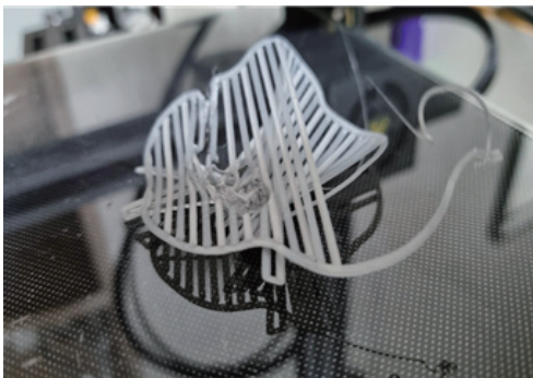
그림 3. 안착 실패사례 Fig. 3 Seating failure case
