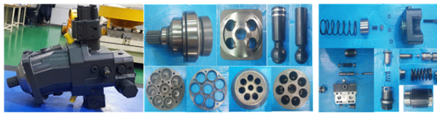
Fig. 3 사축모터 개발품 외형 및 주요부품
