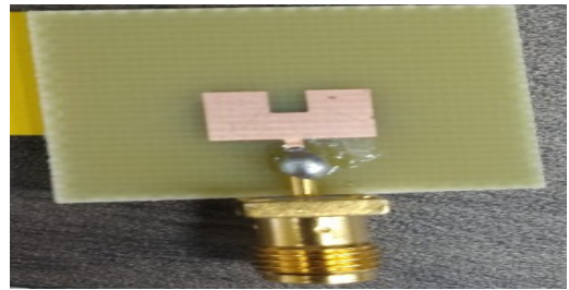
그림 6. 실제 제작한 안테나 Fig. 6 Photo of fabricated antenna
