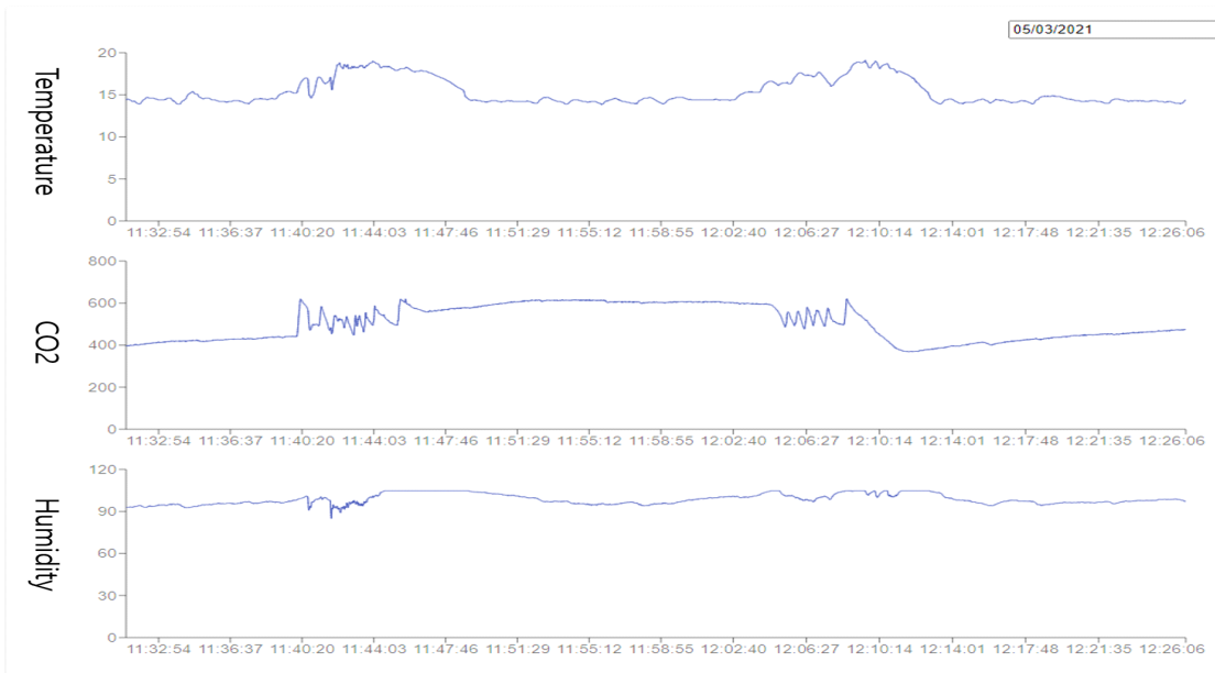
그림 12. 현실세계 식물공장에서 수집된 데이터에 대한 가시화 그래프 조회 화면 Fig. 12. Visualization graph inquiry screen for data collected in real world plant factory
