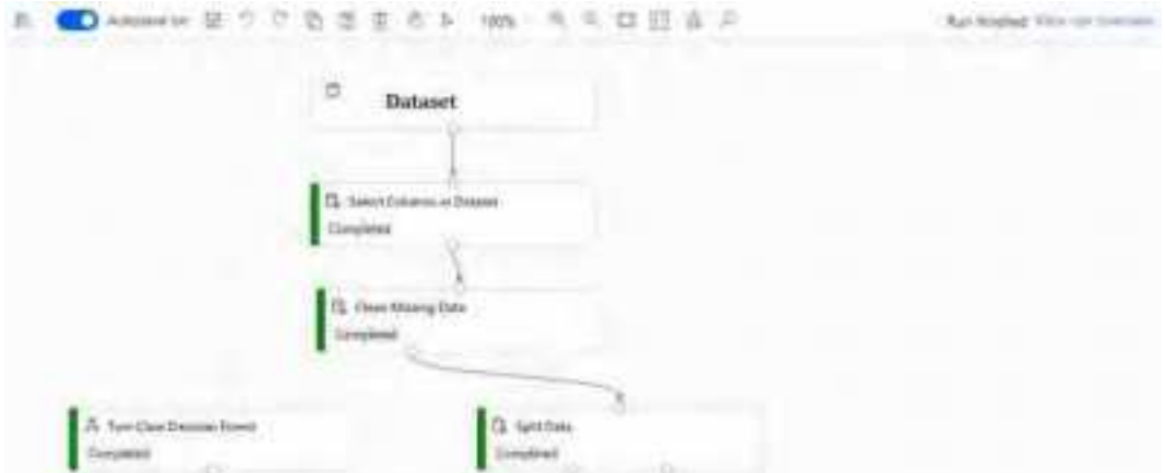
(그림 5) Azure ML에서 제공하는 Data pipeline
