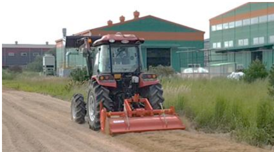
Fig. 2 Actual work using rotavator
