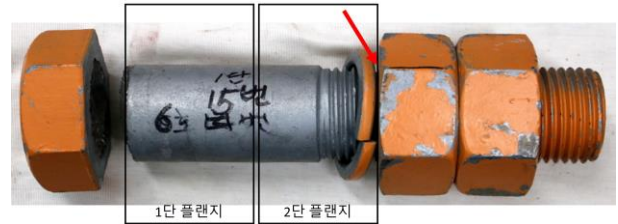
Fig. 4. 조립 상태에서의 너트 위치(최대응력 작용위치 -빨간색화살표)
