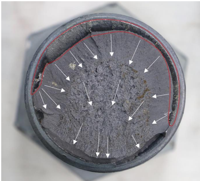
Fig. 8. 볼트 #6 불완전나사부 파면. 사진균열 영역 및 균열 진전 패턴
