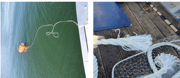
Fig. 9. Rope cutter test result using actual ship.
