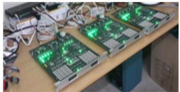
Fig. 8. The mounted board and down loaded FPGA. 그림 8. 실장 보드와 FPGA 다운로드
