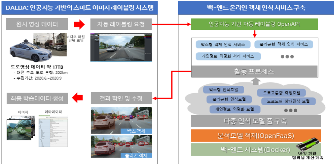
그림 1. 스마트 이미지 레이블링 시스템 DALDA의 자동 레이블링 작업 흐름도
