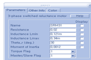
그림 3. 구동 및 제어 시스템 모델링에 적용된 3상 SRM 제원 Fig. 3. Specifications of 3-phase SRM applied to drive and control system modeling
