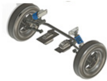
그림 3. 일체 차축식 현가장치 Fig. 3 Solid axle suspension
