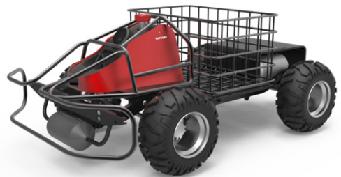
그림 1. 농업용 AI 로봇 외형 구조 설계 Fig. 1 Design of agricultural AI robot structure
