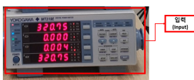
그림 12. 무부하 소비 전력 실험 결과 Fig. 12 No load power consumption test result
