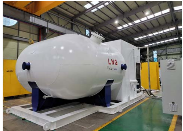
그림 4 한국가스해운 예인선 탑재 LNG 탱크(자유형상압력용기)
