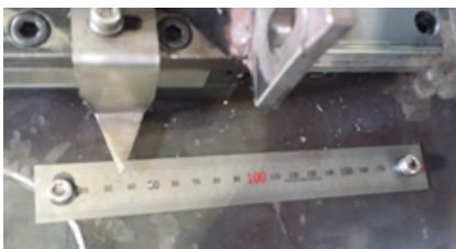
그림 12. 기계적 변형거리 확인 Fig. 12 Check mechanical deformation distance
