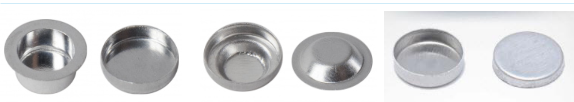
그림 1. DSC용 시료 용기. 출처: TA instruments사와 DSC Consumables 사.
