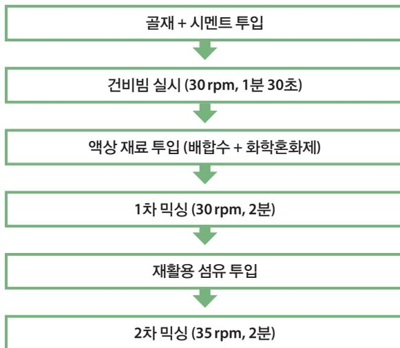
그림 4. 재활용 섬유보강콘크리트 제조순서
